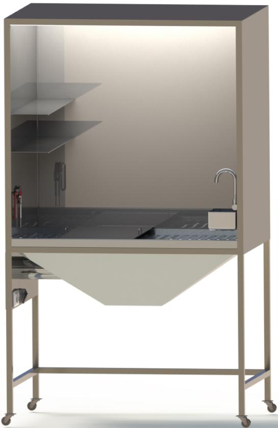
عملیات تمیز کاری تجهیزات آلوده در تست های آزمایشگاهی انواع پودرهای صنعتی (از جمله کنسانتره آهن، سیمان و ...) همواره با مخاطراتی برای سلامت پرسنل آزمایشگاه همراه بوده است. میز تهویه با ایجاد مکش به سمت پایین و در جهت گرانش، از پراکندگی و در نتیجه استنشاق پودرهای مضر توسط سیستم تنفسی در فضای آزمایشگاهی جلوگیری می کند.
