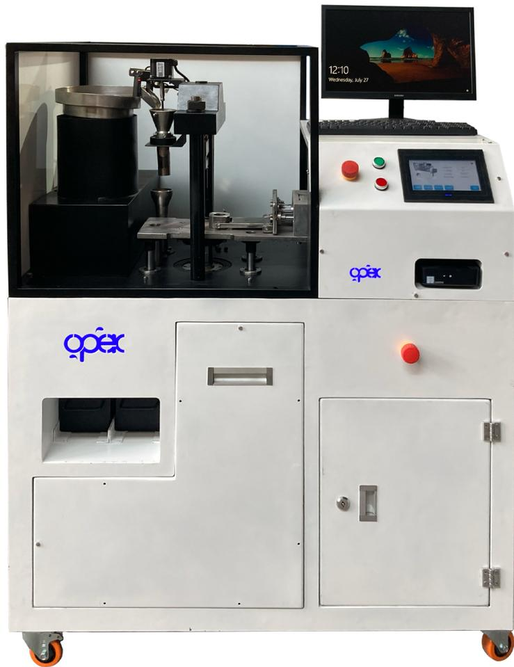
یکی از پارامترهای کنترل کیفیت گندله، میزان استحکام فشاری گندله است که اندازه گیری این پارامتر برای آزمایشگاه های کارخانجات فولاد و واحدهای گندله سازی دارای اهمیت زیادی می باشد.
