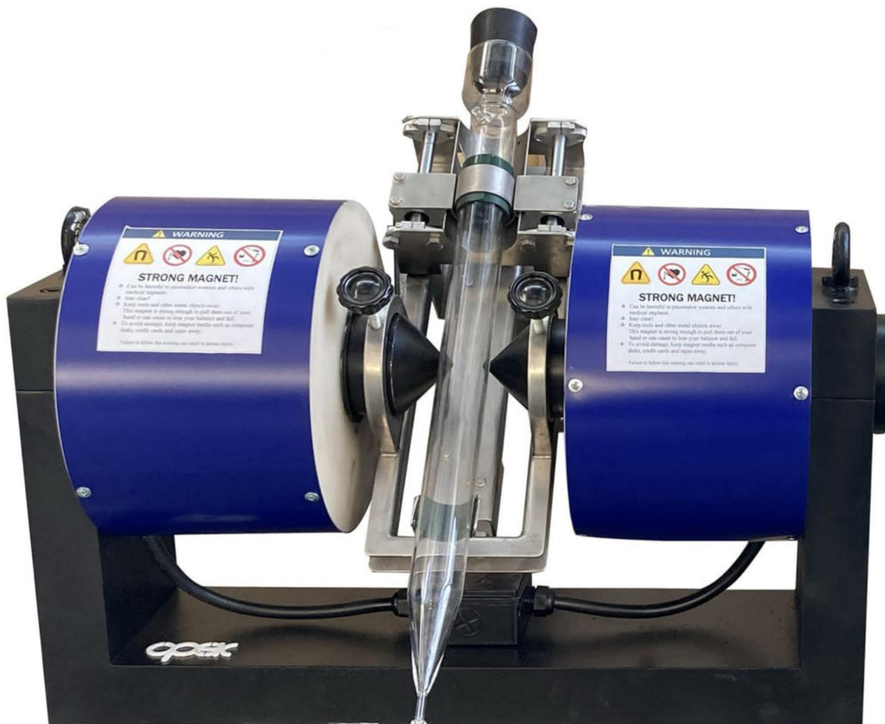
لوله دیویس ابزاری آزمایشگاهی به منظور تفکیک نمونه های معدنی به ذراتی با قدرت مغناطیسی مختلف می باشد. این تجهیز برای جداسازی سنگ های معدنی با شدت مغناطیسی کم نیز قابل استفاده می باشد. یکی از مهم ترین کاربردهای این دستگاه جهت بررسی میزان درصد آهن و اکسید آهن در سنگ های معدنی می باشد.
