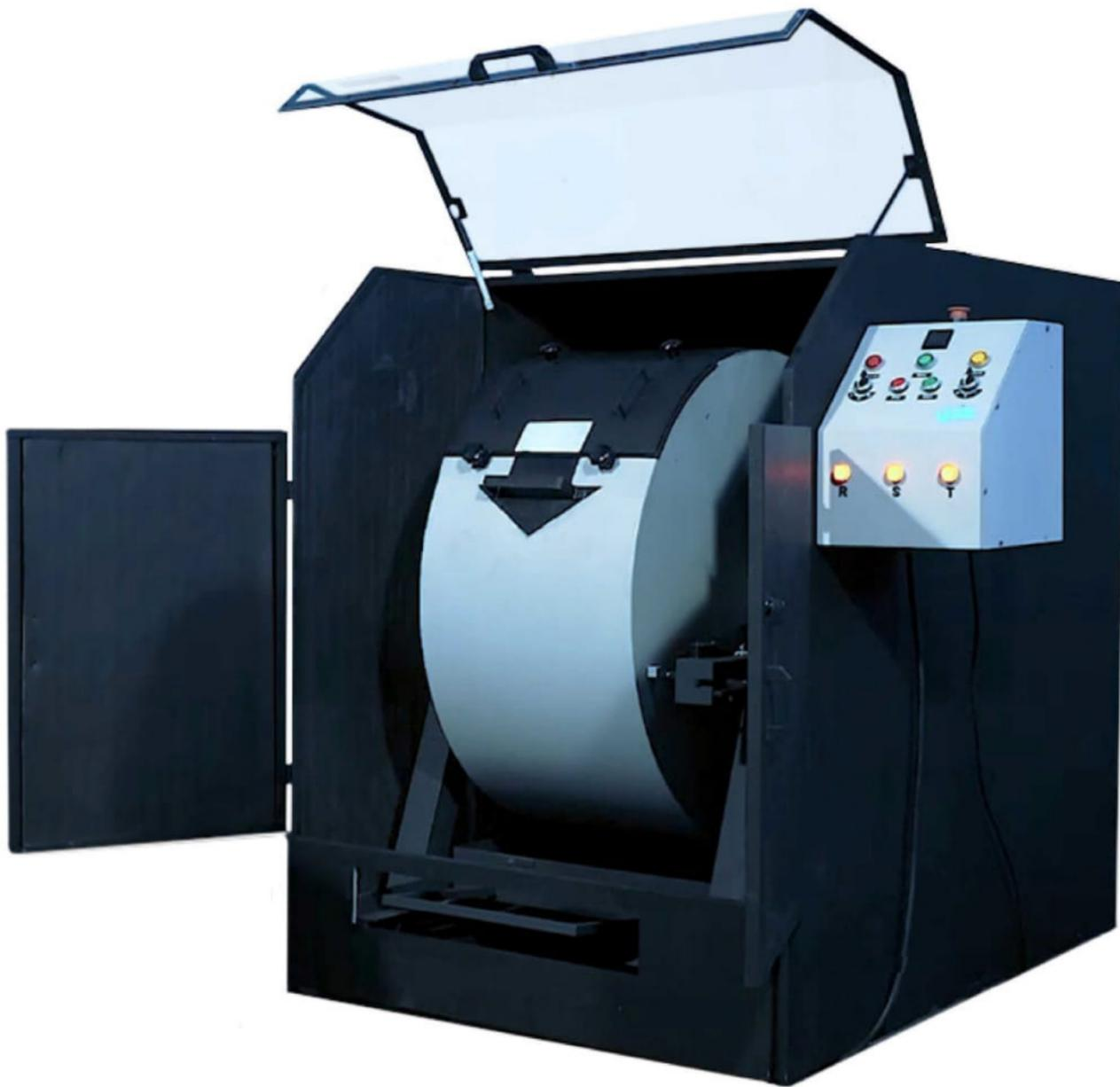
یکی از خواص مکانیکی گندله ها، مقاومت آن ها در برابر ضربه و فرسایش است. دستگاه تست مقاومت سایشی (تست تامبلر) به منظور پیش بینی رفتار تریبولوژیکی مواد و آلیاژهای صنعتی (از جمله گندله) و عمر آن ها در شرایط عملیاتی تحت ضربه، برخورد و سایش بکار می رود.
