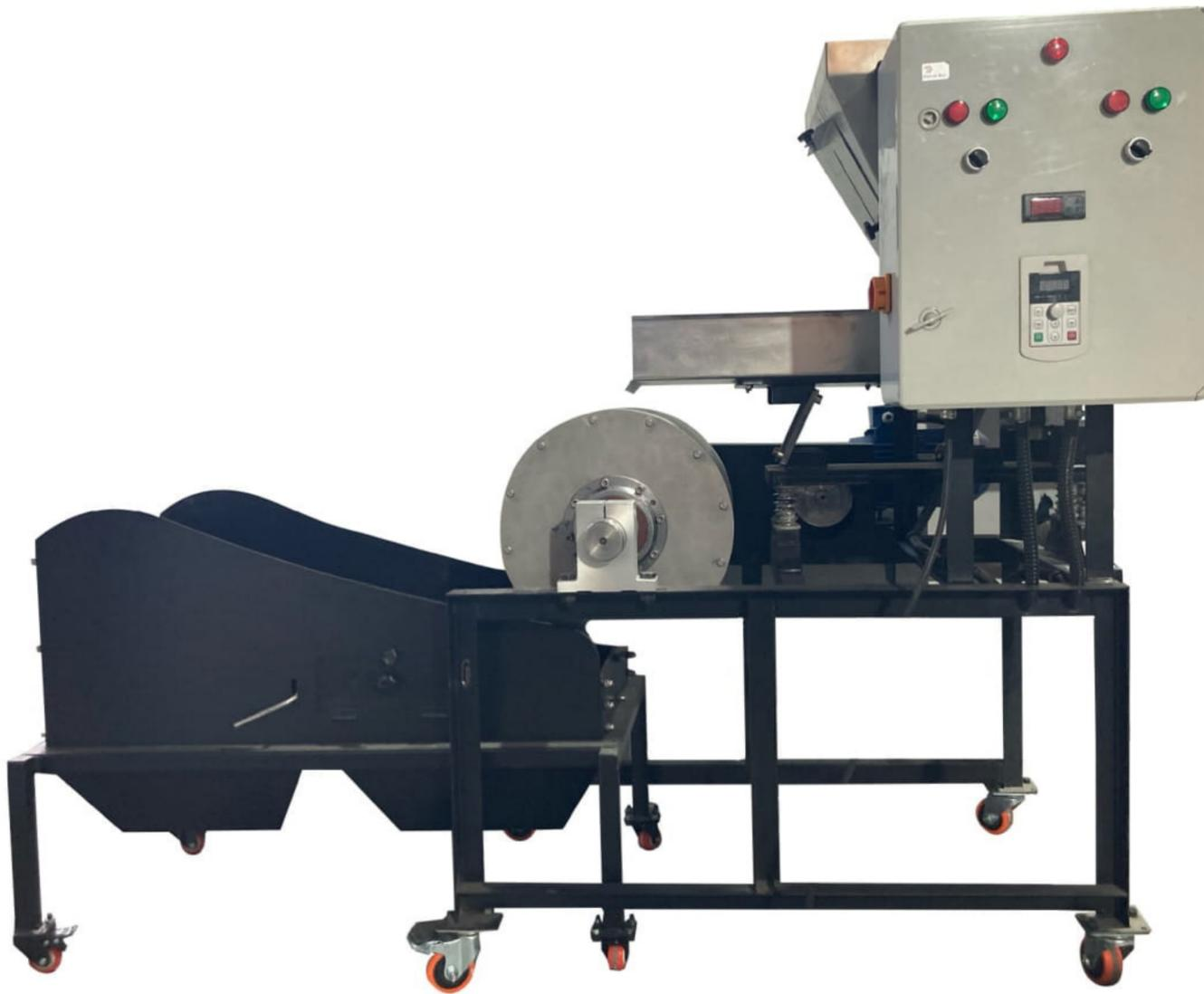
دستگاه درام مگنت خشک برای جداسازی و متمرکز کردن مواد مغناطیسی با استفاده از یک آهنربای ثابت که توسط یک پوسته چرخان احاطه شده است، استفاده می‌شود که حرکت پوسته چرخان، به مواد در تماس با آن منتقل می‌شود.
