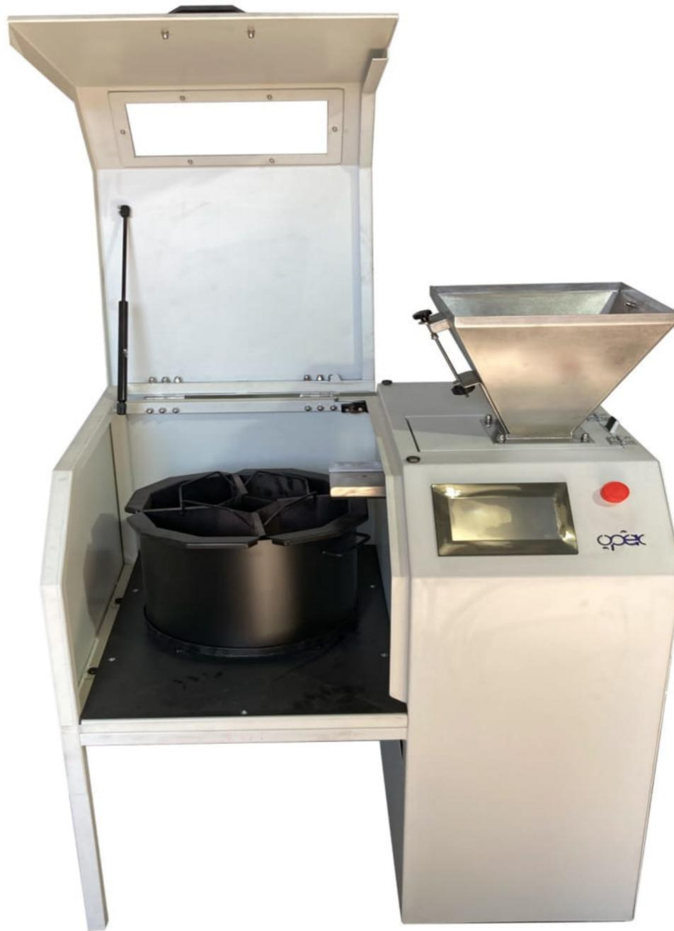
تقسیم کننده های دورانی اتوماتیک که به منظور تقسیم یکنواخت و یا کاهش حجم زیاد نمونه های گرانولی و پودری شکل استفاده می شود.
