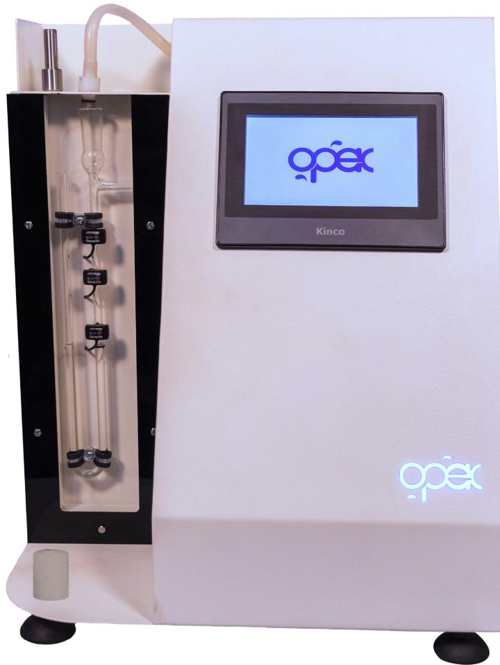
دستگاه تست بلین، سطح مخصوص (سانتی متر مربع بر گرم) را با اندازه گیری نفوذ پذیری هوا در نمونه پودر محاسبه می نماید. سطح مخصوص پودر معیاری برای میزان نرمی نمونه می باشد.
