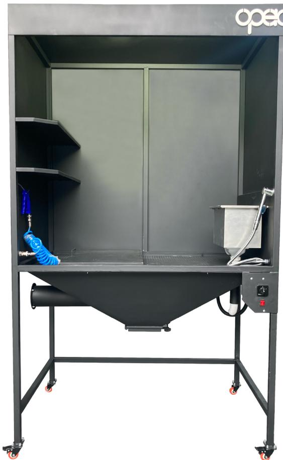
عملیات تمیزکاری تجهیزات آلوده در تست های آزمایشگاهی انواع پودرهای صنعتی (از جمله کنسانتره آهن، سیمان و ...) همواره با مخاطراتی برای سلامت پرسنل آزمایشگاه همراه بوده است. میز تهویه با ایجاد مکش به سمت پایین و در جهت گرانش، از پراکندگی و در نتیجه استنشاق پودرهای مضر توسط سیستم تنفسی در فضای آزمایشگاهی جلوگیری می کند.
