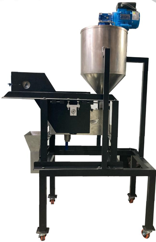
دستگاه درام مگنت تر برای جداسازی و متمرکز کردن مواد مغناطیسی با استفاده از یک آهنربای ثابت که توسط یک پوسته چرخان احاطه شده است، استفاده می شود که حرکت پوسته چرخان، به مواد در تماس با آن منتقل می شود.
