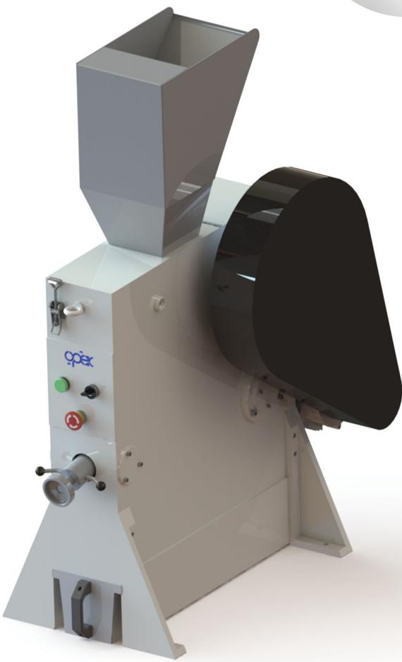
سنگشکن‌ها جزو اولین دستگاه‌ها و تجهیزات در زنجیره آماده‌سازی نمونه برای تجزیه و تحلیل در صنایع معدنی هستند. از سنگشکن فکی برای پیش خرد کردن مواد سخت و شکننده مانند سنگ معدن، سرباره، زغال سنگ سخت یا کلینکر سیمان در آزمایشگاه‌ها، پایلوت پلنت‌ها و کارخانجات فرآوری صنایع معدنی استفاده می‌شود.
